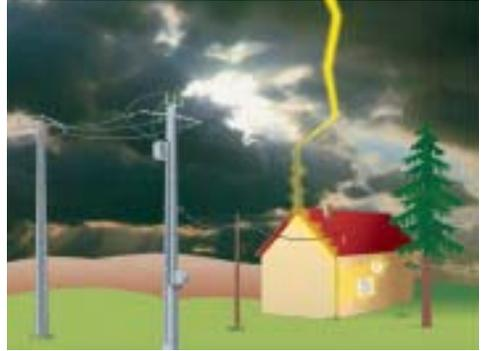
Répartition dans l'installation d'une partie du choc de foudre, en cas d'effets directs avec paratonnerre.
